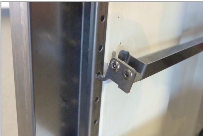
Bild 23: Halterung Zwischenboden in Funktionskiste
