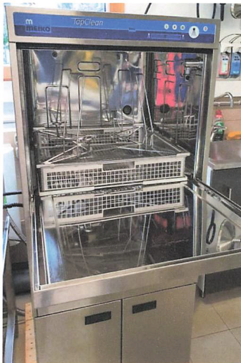
Meiko Korbspüler während der Reinigungstests im Labor Weber & Leucht, Fulda
