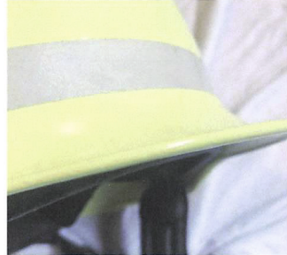
Keine Beschädigungen an den Kanten
