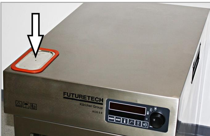
Bild 24: Deckel Wasserbehälter
