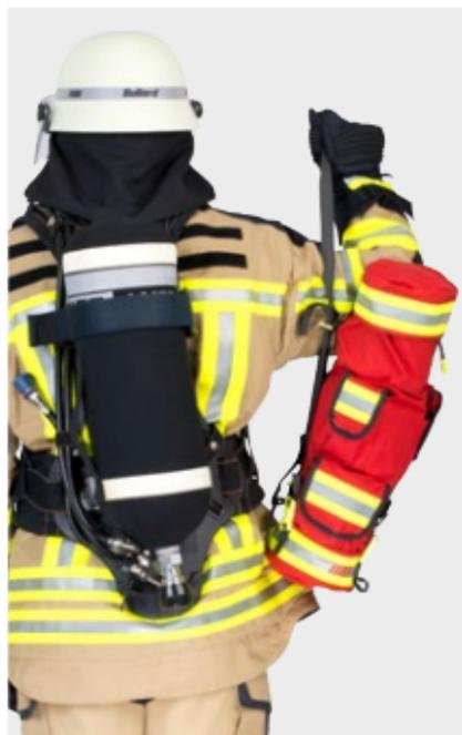
An den rescue-tec Leinenbeuteln sind zwei Notlösevorrichtungen verbaut. Sie stellen sicher, dass sich der Anwender in einer Notsituation (Hängenbleiben) durch eine kräftige Bewegung befreien kann. Die Notlösevorrichtung bricht bei einer Zugkraft von 250–300 N (~ 25–30 kg).
