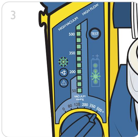
3. Der Test wird direkt gestartet. Im Testmodus blinkt die Ein-Anzeige schnell.
