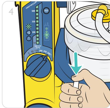
4. Sobald LED 2 aufleuchtet, blockieren Sie den Patientenabsaugschlauch mit dem Daumen.
