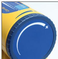
Drehknopf für stufenlose Regulierung des Vakuums (50 - 550 mgHg)
